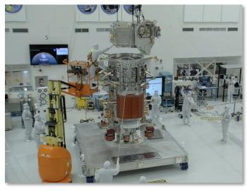
Avionics module atop the propulsion module
